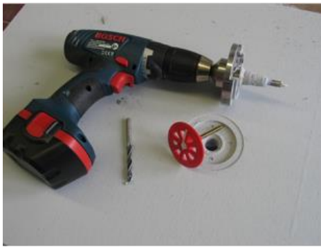
Um eine ebene Fläche zu erreichen, sind die Tellerdübel versenkt anzubringen.
