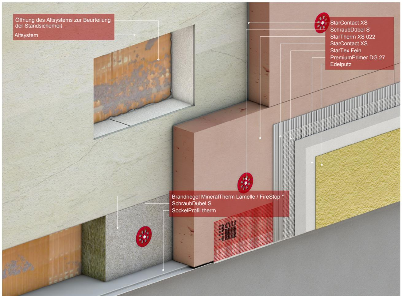
\* Zur Ausführung der konstruktiven Brandschutzmaßnahmen die allgemeine bauaufsichtliche Zulassung Z-33.49-1548 und die technische Systeminformation "WDVS und Brandschutz" des Fachverband WDVSysteme beachten.
