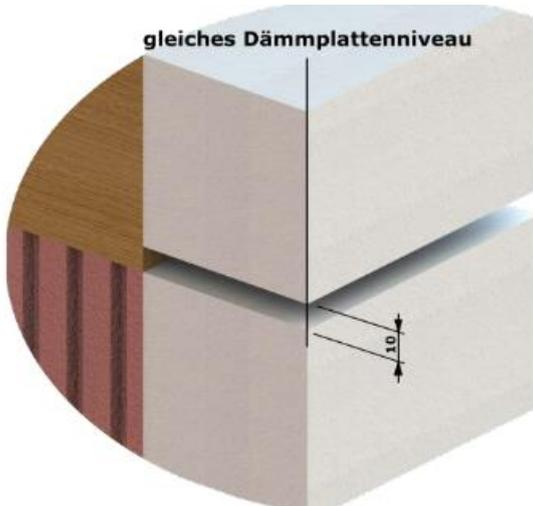
Die untere Dämmplattenreihe muss mit einem 10 mm breiten Fugenabstand zur oberen Dämmplattenreihe verlegt werden. Das gleichmäßige Dämmplattenniveau zwischen den Dämmplattenreihen ggf. mit Hilfe eines Schleifbretts herstellen.
