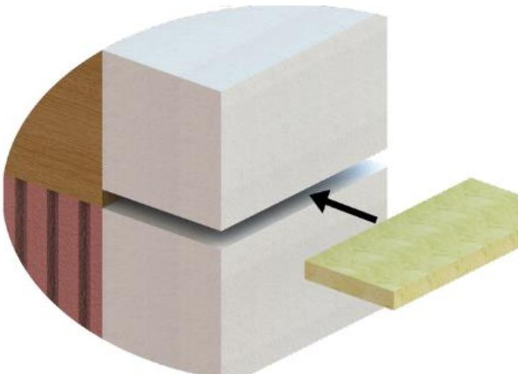
Die 10 mm breite Fuge, abzüglich der Profiltiefe (ca. 15 mm), mit einem passenden Dämmstoff ausfüllen.
