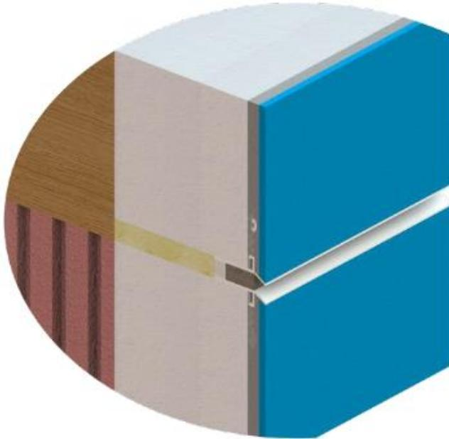
Durch das expandierende Dichtband entsteht eine umlaufend, dauerhaft dichte Quetschfuge.
