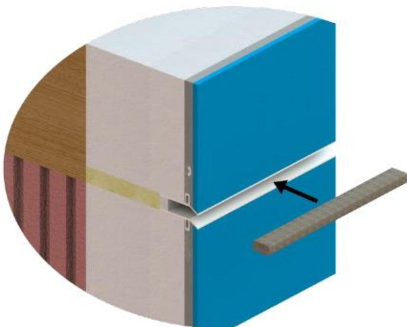
Nach dem Aushärten der Endbeschichtung, das mitgelieferte, komprimierte Dichtband bis zum Schaumband einschieben.
