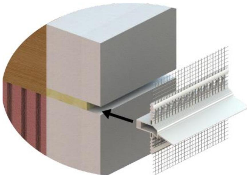
Im Bereich des Gewebestreifens, die Armierung auf die untere und obere Dämmplattenreihe auftragen. Den überstehenden Armierungskleber sauber an der Dämmplattenkante abziehen.
